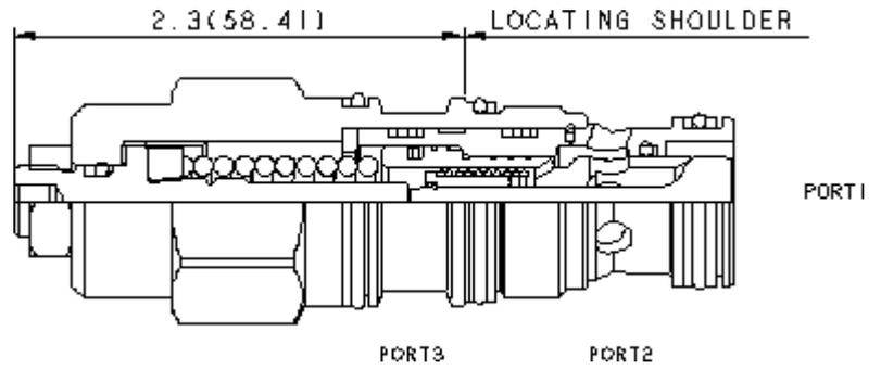
Les valves d'équilibrage assistées par pilotage combinent deux valves; un clapet et un limiteur de pression. Le clapet laisse passer librement le débit depuis le distributeur (chambre 2) vers la charge (chambre 1) alors qu'un limiteur à action directe assisté par un pilotage contrôle le débit de la chambre 1 vers la 2. L'assistance par le pilotage à l'orifice 3 abaisse le tarage effectif du limiteur de pression à une valeur déterminée par le rapport de pilotage.
