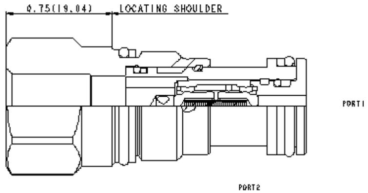
Das Wechsel-Rückschlagventil beinhaltet zwei einfache Rückschlagventile in einem Ventil. Es verbindet die Hochdruckseite zweier Zuläufe mit dem Signalabgriff. Der Anschluss für den externe Signalabgriff ist im Sechskant vom Ventilkopf.
