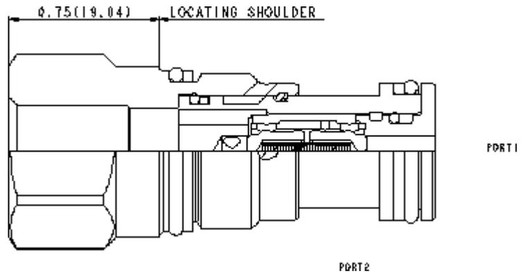
Das Wechsel-Rückschlagventil beinhaltet zwei einfache Rückschlagventile in einem Ventil. Es verbindet die Hochdruckseite zweier Zulaufe mit dem Signalabgriff. Der Anschluss für den externe Signalabgriff ist im Sechskant vom Ventilkopf.
