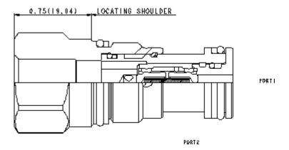
Le sélecteur de circuit à double clapet combine deux clapets anti-retour dans une seule cartouche. Il relie la plus élevée des 2 lignes de pression à l'orifice du signal. Le signal de pression arrive sur un orifice externe situé dans la partie hexagonale de la cartouche.
