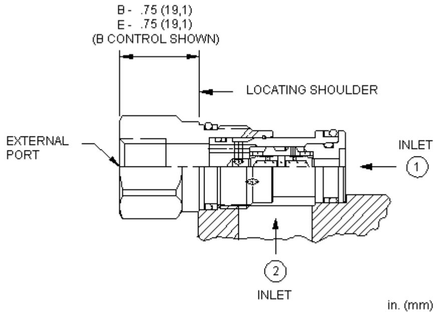
Das Wechsel-Rückschlagventil beinhaltet zwei einfache Rückschlagventile in einem Ventil. Es verbindet die Hochdruckseite zweier Zuläufe mit dem Signalabgriff. Der Anschluss für den externe Signalabgriff ist im Sechskant vom Ventilkopf.
