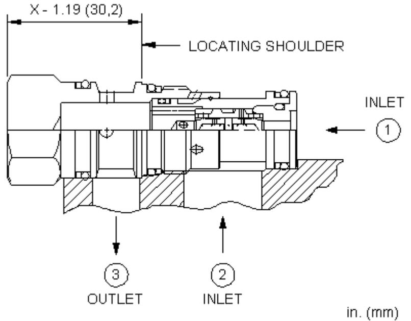
Das Wechsel-Rückschlagventil beinhaltet zwei einfache Rückschlagventile in einem Ventil. Es verbindet den Zulauf mit dem höheren Druck zum Signalabgriff. Der Signalabgriff ist an Anschluss 3.
