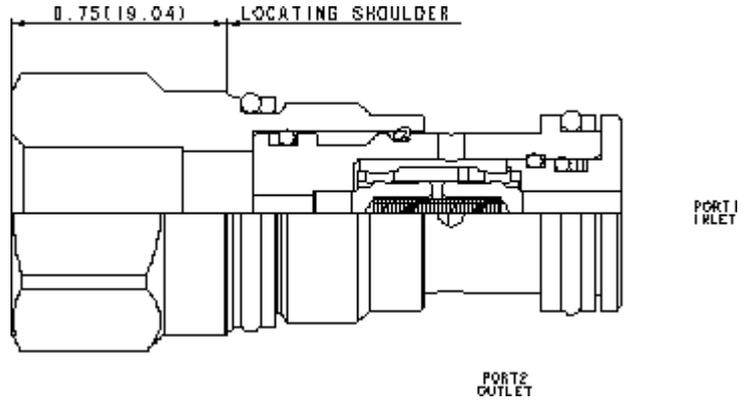
Le sélecteur de circuit à double clapet combine deux clapets anti-retour dans une seule cartouche. Il relie la plus élevée des 2 lignes de pression à l'orifice du signal. L'une des 2 lignes de pression correspond à un orifice externe situé dans la partie hexagonale de la cartouche; le signal de pression arrive sur la chambre 2.
