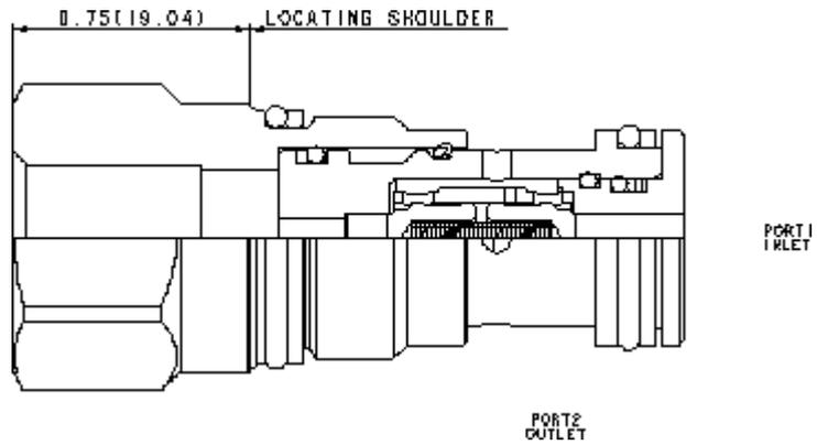
Das Wechsel-Rückschlagventil beinhaltet zwei einfache Rückschlagventile in einem Ventil. Es verbindet die Hochdruckseite zweier Zulaufe mit dem Signalabgriff. Ein Zulauf ist im Sechskant vom Ventilkopf und der Signalabgriff an Anschluss 2.
