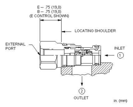
Das Wechsel-Rückschlagventil beinhaltet zwei einfache Rückschlagventile in einem Ventil. Es verbindet die Hochdruckseite zweier Zuläufe mit dem Signalabgriff. Ein Zulauf ist im Sechskant vom Ventilkopf und der Signalabgriff an Anschluss 2.
