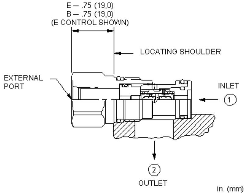
Le sélecteur de circuit à double clapet combine deux clapets anti-retour dans une seule cartouche. Il relie la plus élevée des 2 lignes de pression à l'orifice du signal. L'une des 2 lignes de pression correspond à un orifice externe situé dans la partie hexagonale de la cartouche; le signal de pression arrive sur la chambre 2.
