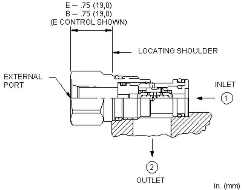
Das Wechsel-Rückschlagventil beinhaltet zwei einfache Rückschlagventile in einem Ventil. Es verbindet die Hochdruckseite zweier Zulaufe mit dem Signalabgriff. Ein Zulauf ist im Sechskant vom Ventilkopf und der Signalabgriff an Anschluss 2.
