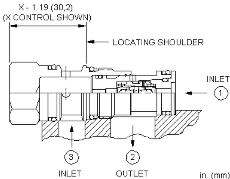
Le sélecteur de circuit à double clapet combine deux clapets anti-retour dans une seule cartouche. Il relie la plus élevée des 2 lignes de pression à l'orifice du signal. Le signal de pression est disponible à la chambre 2.
