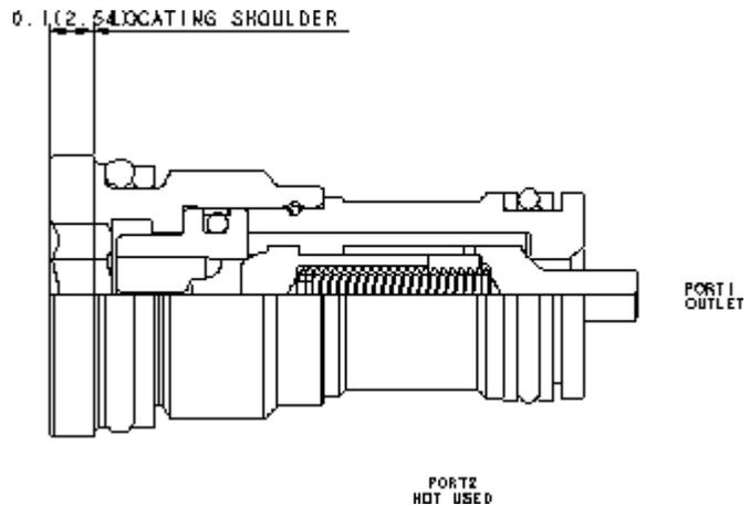
Le clapet à pilotage mécanique est composé d'une paire de clapets en opposition, et celui de la chambre 1 est à actionnement mécanique. Cette valve est à installer dans le piston d'un vérin. Quand le vérin atteint la fin de sa course, le clapet est poussé hors de son siège laissant ainsi passer le débit à travers le piston. Cela permet par exemple à 2 vérins de se réaligner en fin de course dans les deux sens.
