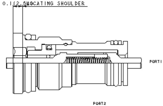
Le clapet à pilotage mécanique est composé d'une paire de clapets en opposition, tous les deux à actionnement mécanique. Cette valve est à installer dans le piston ou la tige d'un vérin. Quand le vérin atteint la fin de sa course, le clapet est poussé hors de son siège laissant ainsi passer le débit à travers le piston. Cela permet par exemple à 2 vérins de se réaligner en fin de course.
