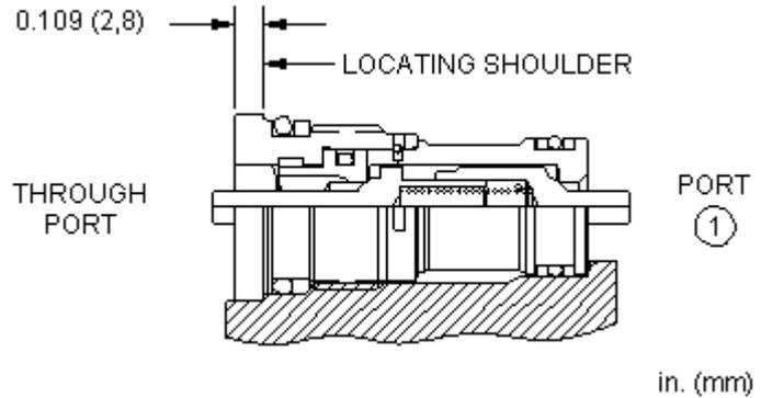
Le clapet à pilotage mécanique est composé d'une paire de clapets en opposition, tous les deux à actionnement mécanique. Cette valve est à installer dans le piston ou la tige d'un vérin. Quand le vérin atteint la fin de sa course, le clapet est poussé hors de son siège laissant ainsi passer le débit à travers le piston. Cela permet par exemple à 2 vérins de se réaligner en fin de course.
