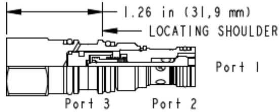
Dieses Ventil ist ein entsperrbares Rückschlagventil. Es hat einen nicht abgedichteten Steuerkolben, einen Stahlsitz und ist ohne Entlastung. Es hat freien Durchfluss zur Last (Anschluss 2 nach 1) und sperrt in Gegenrichtung. Druck an Anschluss 3 öffnet das Ventil von Anschluss 1 nach 2. Der benötigte Steuerdruck an Anschluss 3 ist direkt proportional zum Lastdruck an Anschluss 1. Druck an Anschluss 2 wirkt gegen den Steuerdruck.
