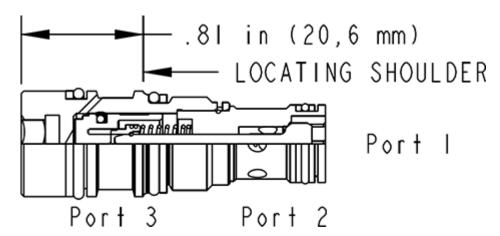
Dieses Ventil ist ein entsperrbares Rückschlagventil. Es hat einen abgedichteten Steuerkolben, einen Stahlsitz und ist ohne Entlastung. Es hat freien Durchfluss zur Last (Anschluss 2 nach 1) und sperrt in Gegenrichtung. Druck an Anschluss 3 öffnet das Ventil von Anschluss 1 nach 2. Der benötigte Steuerdruck an Anschluss 3 ist direkt proportional zum Lastdruck an Anschluss 1. Druck an Anschluss 2 wirkt gegen den Steuerdruck.
