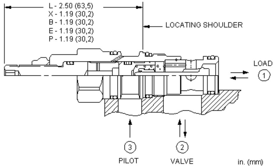
Dieses Ventil ist ein entsperrbares Rückschlagventil. Es hat einen nicht abgedichteten Steuerkolben, einen Stahlsitz und ist ohne Entlastung. Es hat freien Durchfluss zur Last (Anschluss 2 nach 1) und sperrt in Gegenrichtung. Druck an Anschluss 3 öffnet das Ventil von Anschluss 1 nach 2. Der benötigte Steuerdruck an Anschluss 3 ist direkt proportional zum Lastdruck an Anschluss 1. Druck an Anschluss 2 wirkt gegen den Steuerdruck.
