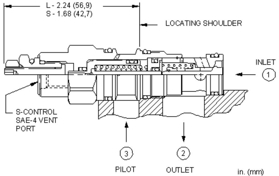
Dieses Ventil ist ein entsperrenbares Rückschlagventil. Es hat einen abgedichteten Steuerkolben, einen Stahlsitz und ist entlastet. Es hat freien Durchfluss zur Last (Anschluss 2 nach 1) und sperrt in Gegenrichtung. Druck an Anschluss 3 öffnet das Ventil von Anschluss 1 nach 2. Der benötigte Steuerdruck ist direkt proportional zum Lastdruck an Anschluss 1. Das Ventil ist unabhängig von Druck an Anschluss 2, da der Federraum zum externen Anschluss im Sechskant entlastet ist.
