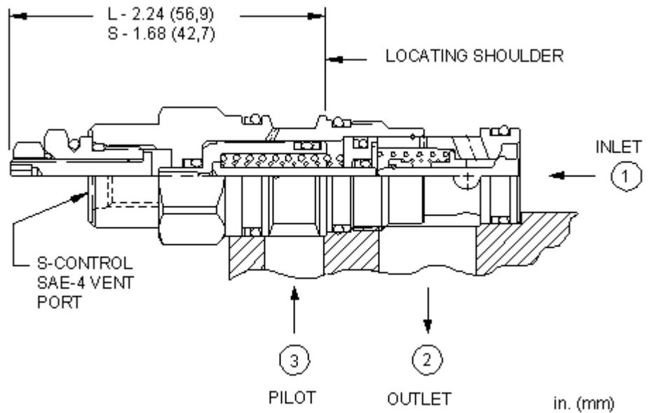
Dieses Ventil ist ein entsperbares Rückschlagventil. Es hat einen abgedichteten Steuerkolben, einen Stahlsitz und ist entlastet. Es hat freien Durchfluss zur Last (Anschluss 2 nach 1) und sperrt in Gegenrichtung. Druck an Anschluss 3 öffnet das Ventil von Anschluss 1 nach 2. Der benötigte Steuerdruck ist direkt proportional zum Lastdruck an Anschluss 1. Das Ventil ist unabhängig von Druck an Anschluss 2, da der Federraum zum externen Anschluss im Sechskant entlastet ist.
