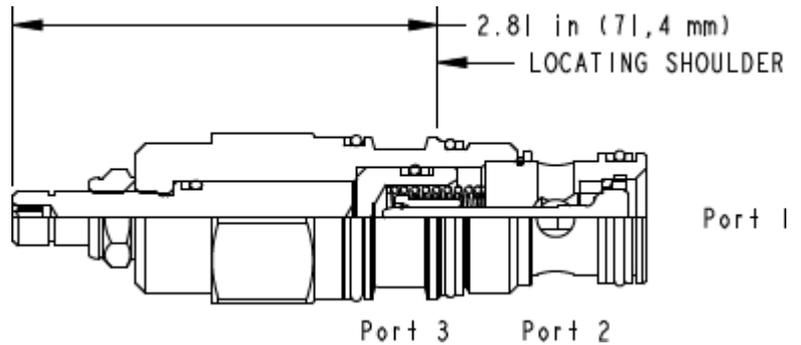
Dieses Ventil ist ein entsperrbares Rückschlagventil. Es hat einen abgedichteten Steuerkolben, einen Delrinsitz und ist ohne Entlastung. Es hat freien Durchfluss zur Last (Anschluss 2 nach 1) und sperrt in Gegenrichtung. Druck an Anschluss 3 öffnet das Ventil von Anschluss 1 nach 2. Der benötigte Steuerdruck an Anschluss 3 ist direkt proportional zum Lastdruck an Anschluss 1. Druck an Anschluss 2 wirkt gegen den Steuerdruck.
