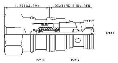
Dieses Ventil ist ein entsperrbares Rückschlagventil. Es hat einen abgedichteten Steuerkolben, einen Stahlsitz und ist
