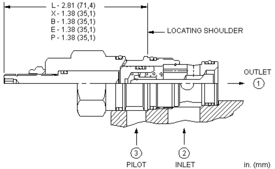
Dieses Ventil ist ein entsperrbares Rückschlagventil. Es hat einen abgedichteten Steuerkolben, einen Stahlsitz und ist ohne Entlastung. Es hat freien Durchfluss zur Last (Anschluss 2 nach 1) und sperrt in Gegenrichtung. Druck an Anschluss 3 öffnet das Ventil von Anschluss 1 nach 2. Der benötigte Steuerdruck an Anschluss 3 ist direkt proportional zum Lastdruck an Anschluss 1. Druck an Anschluss 2 wirkt gegen den Steuerdruck.
