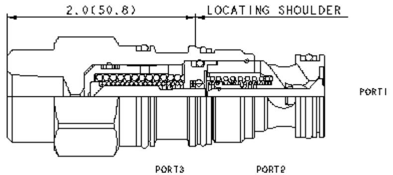
Dieses Ventil ist ein entsperbares Rückschlagventil. Es hat einen abgedichteten Steuerkolben, einen Stahlsitz und ist entlastet. Es hat freien Durchfluss zur Last (Anschluss 2 nach 1) und sperrt in Gegenrichtung. Druck am externen Anschluss öffnet das Ventil von Anschluss 1 nach 2. Der benötigte Steuerdruck ist direkt proportional zum Lastdruck an Anschluss 1. Das Ventil ist unabhängig von Druck an Anschluss 2, da der Federraum zum Anschluss 3 entlastet ist.
