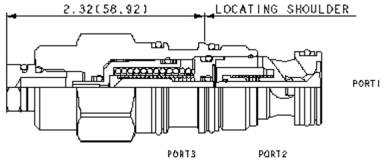
Dieses Ventil ist ein entsperrbares Rückschlagventil. Es hat einen abgedichteten Steuerkolben, einen Stahlsitz und ist entlastet. Es hat freien Durchfluss zur Last (Anschluss 2 nach 1) und sperrt in Gegenrichtung. Druck an Anschluss 3 öffnet das Ventil von Anschluss 1 nach 2. Der benötigte Steuerdruck ist direkt proportional zum Lastdruck an Anschluss 1. Das Ventil ist unabhängig von Druck an Anschluss 2, da der Federraum zum externen Anschluss im Sechskant entlastet ist.
