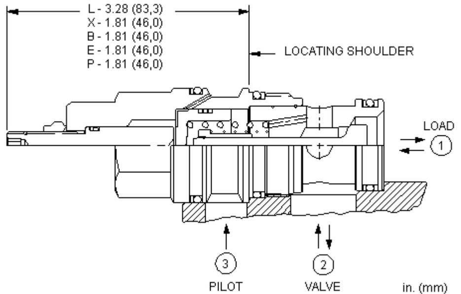
Dieses Ventil ist ein entsperrbares Rückschlagventil. Es hat einen nicht abgedichteten Steuerkolben, einen Stahlsitz und ist ohne Entlastung. Es hat freien Durchfluss zur Last (Anschluss 2 nach 1) und sperrt in Gegenrichtung. Druck an Anschluss 3 öffnet das Ventil von Anschluss 1 nach 2. Der benötigte Steuerdruck an Anschluss 3 ist direkt proportional zum Lastdruck an Anschluss 1. Druck an Anschluss 2 wirkt gegen den Steuerdruck.
