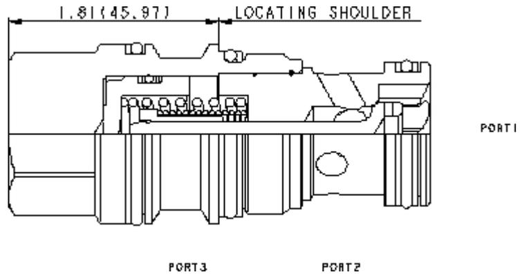
Dieses Ventil ist ein entsperrbares Rückschlagventil. Es hat einen abgedichteten Steuerkolben, einen Stahlsitz und ist ohne Entlastung. Es hat freien Durchfluss zur Last (Anschluss 2 nach 1) und sperrt in Gegenrichtung. Druck an Anschluss 3 öffnet das Ventil von Anschluss 1 nach 2. Der benötigte Steuerdruck an Anschluss 3 ist direkt proportional zum Lastdruck an Anschluss 1. Druck an Anschluss 2 wirkt gegen den Steuerdruck.
