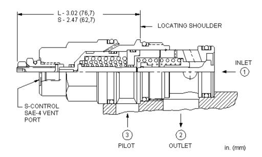
Dieses Ventil ist ein entsperrbares Rückschlagventil. Es hat einen abgedichteten Steuerkolben, einen Stahlsitz und ist entlastet. Es hat freien Durchfluss zur Last (Anschluss 2 nach 1) und sperrt in Gegenrichtung. Druck an Anschluss 3 öffnet das Ventil von Anschluss 1 nach 2. Der benötigte Steuerdruck ist direkt proportional zum Lastdruck an Anschluss 1. Das Ventil ist unabhängig von Druck an Anschluss 2, da der Federraum zum externen Anschluss im Sechskant entlastet ist.
