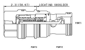
Dieses Ventil ist ein entsperrbares Rückschlagventil. Es hat einen abgedichteten Steuerkolben, einen Delrinsitz und ist
