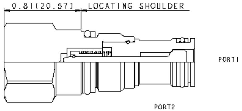
Dieses Drosselventil hat eine Festblende und ein Umgehungs-rückschlagventil. Das Ventil wird werkseitig auf den vorgegebenen Wert eingestellt.
