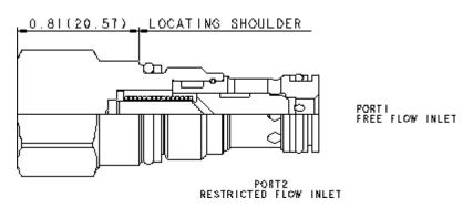
Les clapets anti-retour avec gicleur en parallèle laissent passer librement le débit de l'orifice 1 vers l'orifice 2 et le contrôlent par un gicleur calibré selon les besoins du client de 2 vers 1. Voir les informations techniques cidessous pour la gamme de gicleurs.
