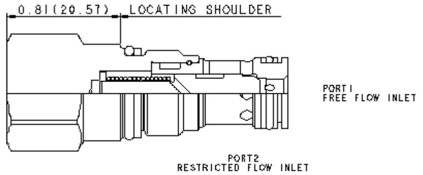
Les clapets anti-retour avec gicleur en parallèle laissent passer librement le débit de l'orifice 1 vers l'orifice 2 et le contrôlent par un gicleur calibré selon les besoins du client de 2 vers 1. Voir les informations techniques ci-dessous pour la gamme de gicleurs.
