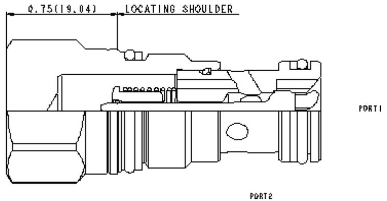
Dieses Drosselventil hat eine Festblende und ein Umgehungsrückschlagventil. Das Ventil wird werkseitig auf den vorgegebenen Wert eingestellt.
