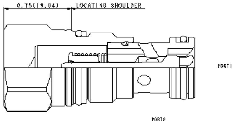
Cette valve est un gicleur calibré non compensé en pression avec un clapet de by-pass. Le gicleur est percé en usine au diamètre spécifié par le client.
