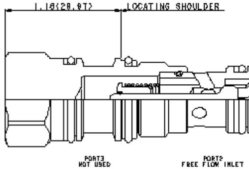
Dieses Rückschlagventil mit Bypassblende erfüllt die Funktion eines fest eingestellten Drosselrückschlagventils in einer Einschraubbohrung mit drei Anschlüssen. Der freie Durchfluss ist von Anschluss 2 nach 1. Die Ventile haben einen vom Kunden anzugebenden Blendendurchmesser, der den Volumenstrom von Anschluss 1 nach 2 drosselt. Anschluss 3 ist verschlossen.
