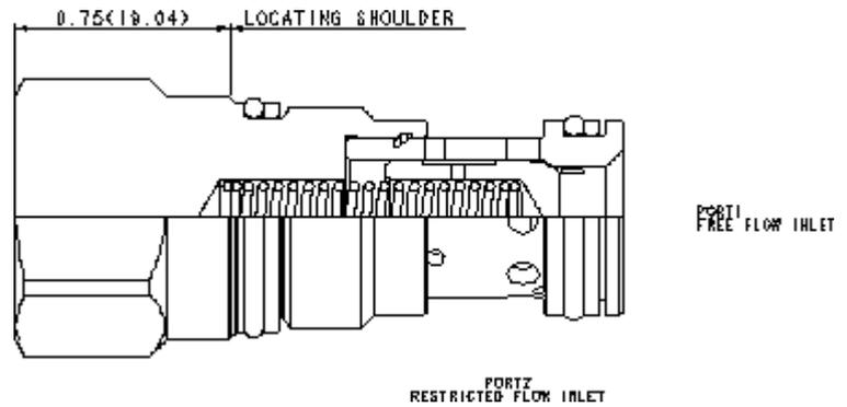
Les clapets anti-retour avec gicleur en parallèle laissent passer librement le débit de l'orifice 1 vers l'orifice 2 et le contrôlent par un gicleur calibré selon les besoins du client de 2 vers 1. Voir les informations techniques ci-dessous pour la gamme de gicleurs.
