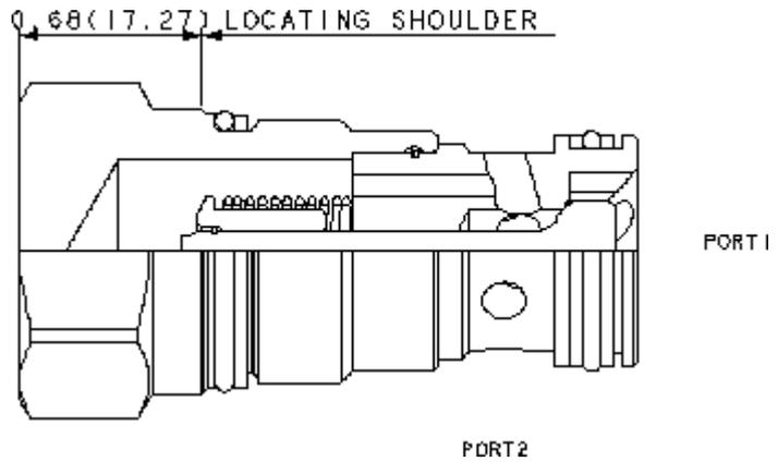
Cette valve est un gicleur calibré non compensé en pression avec un clapet de by-pass. Le gicleur est percé en usine au diamètre spécifié par le client.
