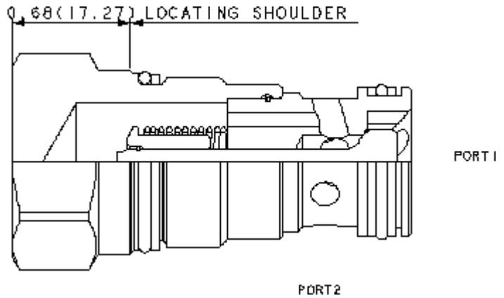
Cette valve est un gicleur calibré non compensé en pression avec un clapet de by-pass. Le gicleur est percé en usine au diamètre spécifié par le client.
