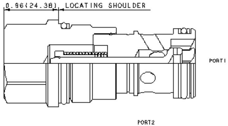
Dieses Drosselventil hat eine Festblende und ein Umgehungs-rückschlagventil. Das Ventil wird werkseitig auf den vorgegebenen Wert eingestellt.
