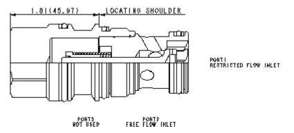
Dieses Rückschlagventil mit Bypassblende erfüllt die Funktion eines fest eingestellten Drosselrückschlagventils in einer Einschraubbohrung mit drei Anschlüssen. Der freie Durchfluss ist von Anschluss 2 nach 1. Die Ventile haben einen vom Kunden anzugebenden Blendendurchmesser, der den Volumenstrom von Anschluss 1 nach 2 drosselt. Anschluss 3 ist verschlossen.
