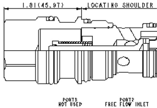
Dieses Rückschlagventil mit Bypassblende erfüllt die Funktion eines fest eingestellten Drosselrückschlagventils in einer Einschraubbohrung mit drei Anschlüssen. Der freie Durchfluss ist von Anschluss 2 nach 1. Die Ventile haben einen vom Kunden anzugebenden Blendendurchmesser, der den Volumenstrom von Anschluss 1 nach 2 drosselt. Anschluss 3 ist verschlossen.
