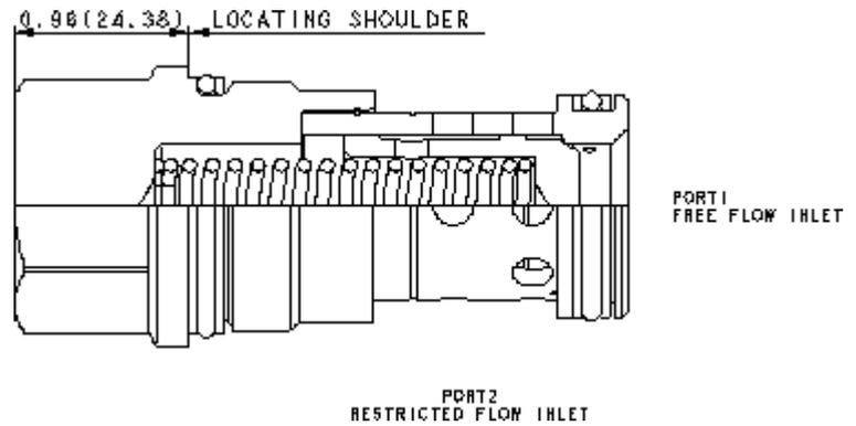
Les clapets anti-retour avec gicleur en parallèle laissent passer librement le débit de l'orifice 1 vers l'orifice 2 et le contrôlent par un gicleur calibré selon les besoins du client de 2 vers 1. Voir les informations techniques ci-dessous pour la gamme de gicleurs.
