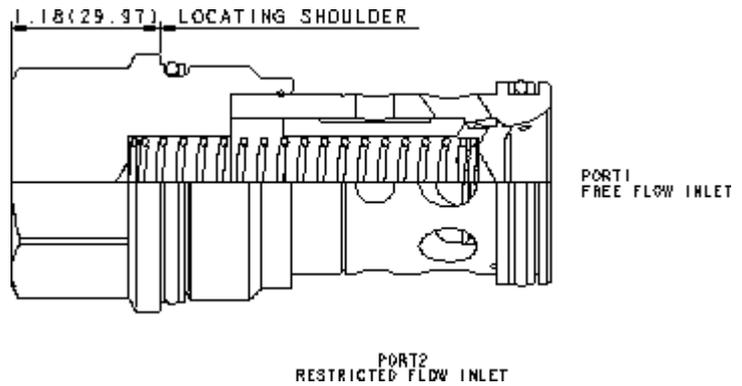
Les clapets anti-retour avec gicleur en parallèle laissent passer librement le débit de l'orifice 1 vers l'orifice 2 et le contrôlent par un gicleur calibré selon les besoins du client de 2 vers 1. Voir les informations techniques ci-dessous pour la gamme de gicleurs.
