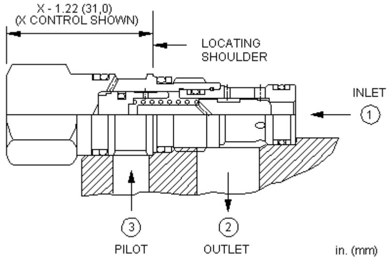
Dieses Ventil ist ein in der Ruhestellung geschlossenes, sperrbares Rückschlagventil mit einem Zusteuerverhältnis von 3:1. Das Ventil erlaubt einen Durchfluss von Anschluss 1 nach 2 und blockiert in umgekehrter Richtung. Druck am externen Steueranschluss wirkt dem Druck an Anschluss 1 im Verhältnis von 3:1 entgegen. Anschluss 3 ist gesperrt. Das Ventil wird häufig in Eilgangschaltungen eingesetzt.
