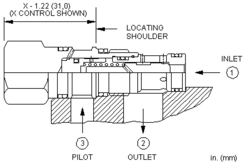
Dieses Ventil ist ein in der Ruhestellung geschlossenes, sperrbares Rückschlagventil mit einem Zusteuerungsverhältnis von 3:1. Das Ventil erlaubt einen Durchfluss von Anschluss 1 nach 2 und blockiert in umgekehrter Richtung. Druck am externen Steueranschluss wirkt dem Druck an Anschluss 1 im Verhältnis von 3:1 entgegen. Anschluss 3 ist gesperrt. Das Ventil wird häufig in Eilgangschaltungen eingesetzt.
