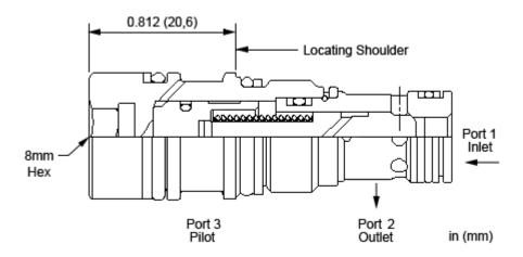
Dieses Ventil ist ein in der Ruhestellung geschlossenes, sperrbares Rückschlagventil mit einen Zusteuerverhältnis von 1,8:1. Das Ventil erlaubt einen Durchfluss von Anschluss 1 nach 2 und blockiert in umgekehrter Richtung. Druck am Zusteueranschluss 3 wirkt dem Druck an Anschluss 1 im Verhältnis von 1,8:1 entgegen. Dieses Ventil findet hauptsächlich in Eilgangschaltungen Verwendung.
