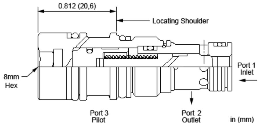
Dieses Ventil ist ein in der Ruhestellung geschlossenes, sperrbares Rückschlagventil mit einem Zusteuerungsverhältnis von 1,8:1. Das Ventil erlaubt einen Durchfluss von Anschluss 1 nach 2 und blockiert in umgekehrter Richtung. Druck am Zusteueranschluss 3 wirkt dem Druck an Anschluss 1 im Verhältnis von 1,8:1 entgegen. Dieses Ventil findet hauptsächlich in Eilgangschaltungen Verwendung.
