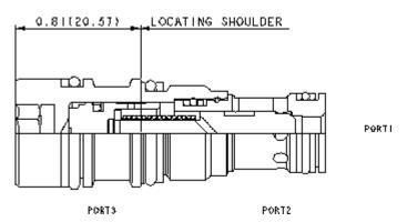
Ce clapet anti-retour qui se ferme quand on le pilote est normalement fermé au repos par ressort, et a un rapport de
