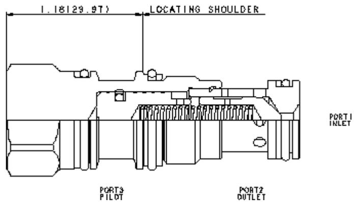
Ce clapet anti-retour qui se ferme quand on le pilote est normalement fermé par ressort, et a un rapport de pilotage de 20/1. Il laisse passer le débit de la chambre 1 vers la chambre 2 et le bloque en sens inverse. La pression de la ligne de pilotage (chambre 3) s'oppose à la pression de la chambre 1 dans un rapport de 20/1.
