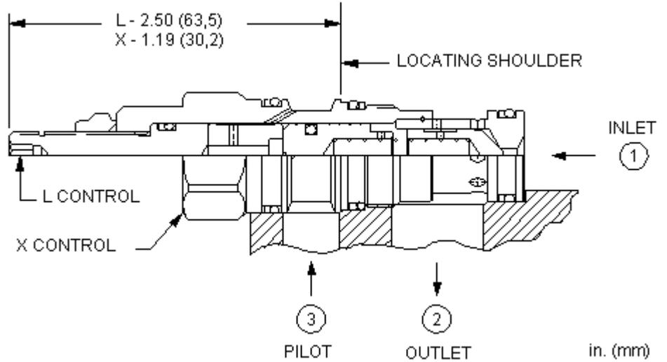
Dieses Ventil ist ein in der Ruhestellung geschlossenes, sperrbares Rückschlagventil mit einem Zusteuerverhältnis von 20:1. Das Ventil erlaubt einen Durchfluss von Anschluss 1 nach 2 und blockiert in umgekehrter Richtung. Druck am Zusteueranschluss 3 wirkt dem Druck an Anschluss 1 im Verhältnis von 20:1 entgegen.
